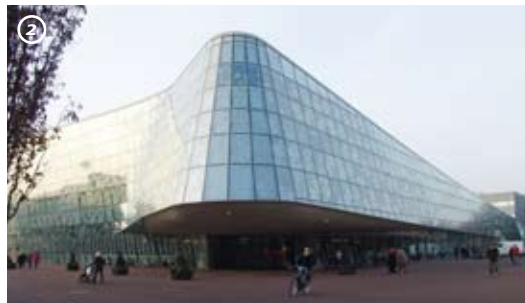
1 & 2: Frameless glazing of the cityhall in Alphen aan den Rijn, NL (architect: Erick van Egeraat Associates)
